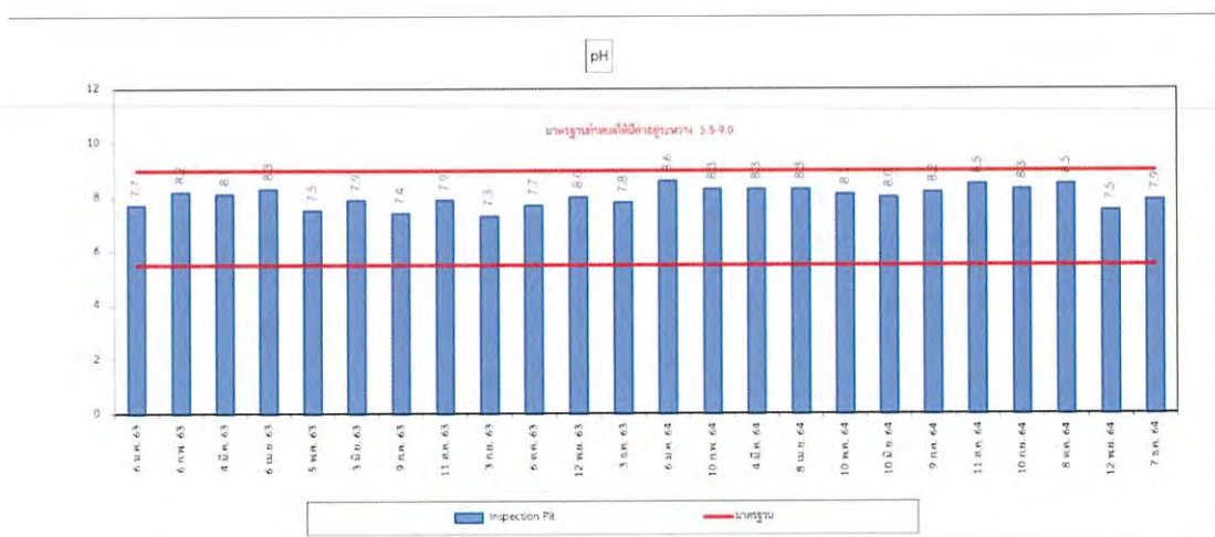
รูปที่ 3.4-4 กราฟแสดงผลการตรวจวัดคุณภาพน้ำ บริเวณถัง Waste Water Inspection Pit (V89-N) ขนาด 100 ลบ.ม. ระหว่างปี พ.ศ. 2563-2564
